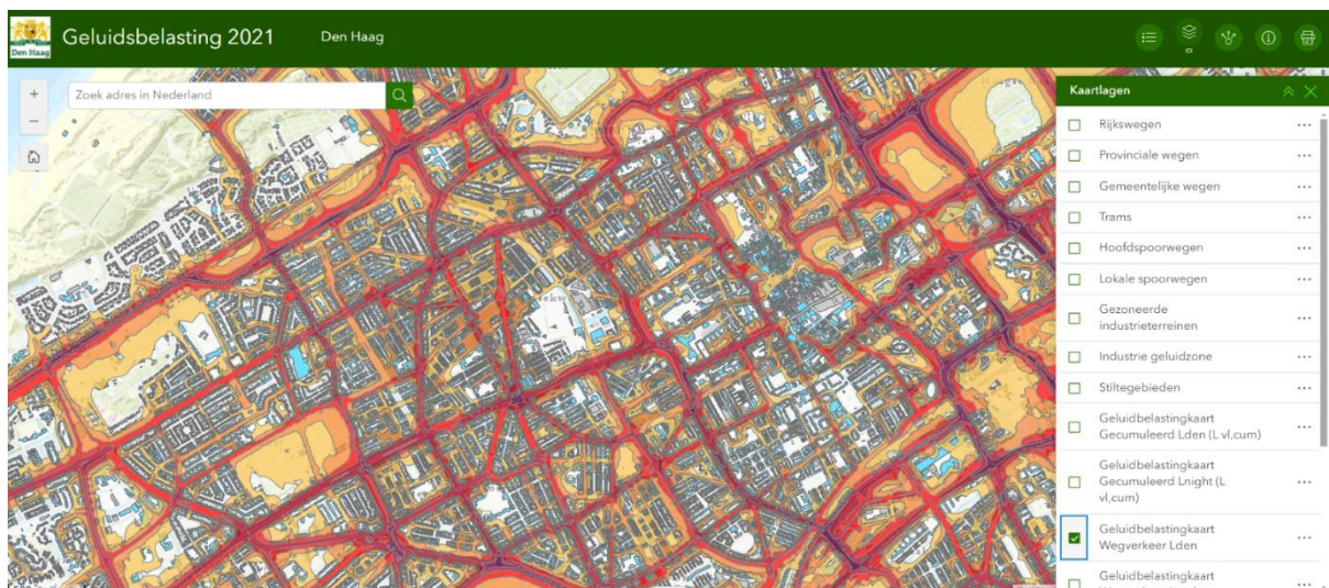
Figuur 1 Geluidbelastingkaart voor wegverkeer in 2021, berekend met de Europese rekenmethode CNOSSOS
